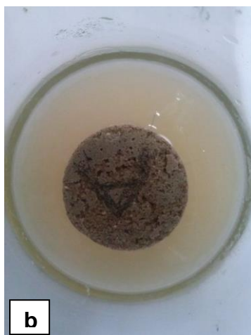
Rys. 7. Obraz makroskopowy trzytygodniowych hodowli grzyba Trichoderma koningii towarzyszących a) zaprawie bazowej b) próbkom tynków zawierających dodatek gruntu srebronośnego
